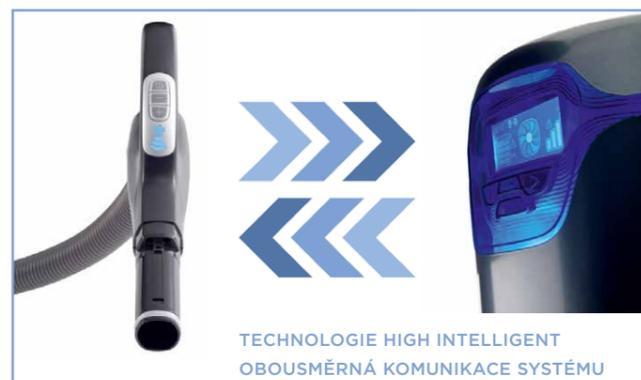
Mikrospínač na hadici umožňuje regulaci výkonu vysavače, zapnutí a vypnutí celého systému. Podsvícený LCD displej na agregátu a LED signalizace na rukojeti vysávací hadice informují uživatele o činnosti vysavače a jeho aktuálním stavu, případně jej upozorňují na potřebu vyprázdnění prachového kanystru.
